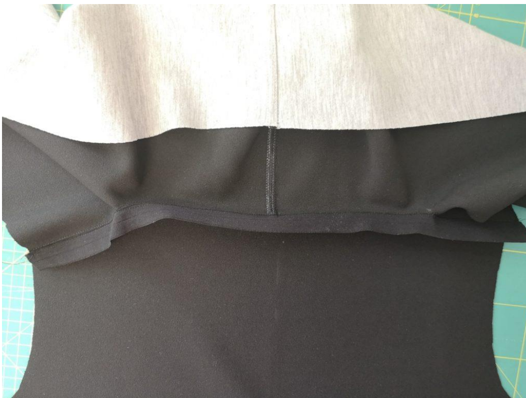
31. Na vzniklý šev v kraji našijeme lemovací pruženku. Kraj lemovací pruženky leží těsně u stehů.
